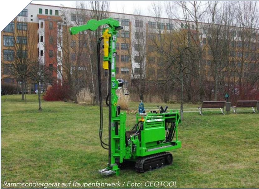
Rammsondiergerät auf Raupenfahwerk / Foto: GEOTOOL
